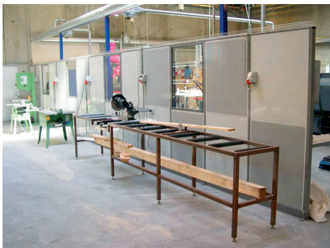
Absorberende skærmvæg med glaspartier
